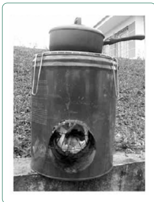
Fogão tipo “Rocket Stove” construído com sucata do ferro velho - Irati, Paraná Fonte: Machado et al. (2015)
