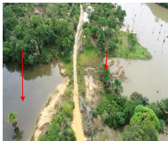
Fig. 17e 18: Águas represadas com formação de lagoas, possivelmente áreas de nascentes e processos erosivos e consequente assoreamento do igarapé do leão.
