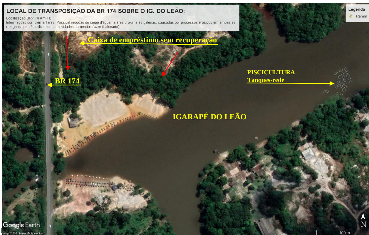
Fig. 16: A áreas assoreadas que arrastão material sedimentar para o leito do igarapé.
